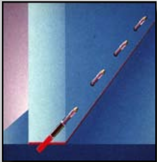
1. Wand/Sohlenanschluss Bodenplatte auf Streifen- oder Einzelfundament aufliegend
