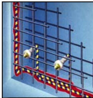
10. Rohrdurchführung Decke, Wand, Boden Elastische Dichtung
