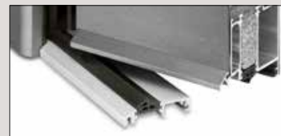
Wetterschenkel im Flügel vernietet, Wasser tropft vor der Schwelle ab
