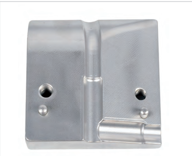
Klemmbacke für Kunststoffrohr Steckermontage 3D gefräst 80x80x30, Werkstoff: 1.4301 Edelstahl, Oberfläche: roh
