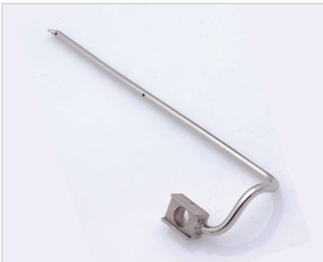
Rohr D=5x1 mm mit angesetztem Frästeil, Werkstoff: 1.4571 Edelstahl, Oberfläche: elektroliert
