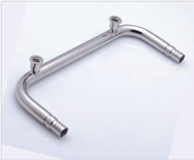
Rohrbiegeteil mit angedrehten Enden und angeschweißten Drehteilen, Werkstoff: Edelstahl, Oberfläche: elektroliert
