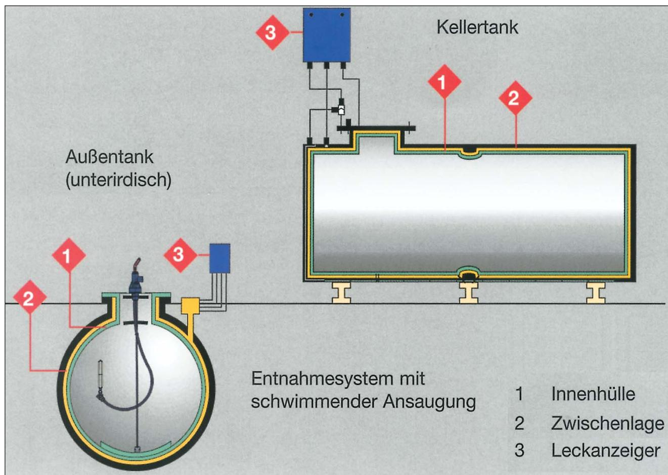
ALLE Leistungen können auch im Winter – bei gefülltem / teilgefülltem Tank – ausgeführt werden. Der Heizbetrieb/ Warmwasserbetrieb geht weiter. Montagezeit: Leckschutz-Auskleidung (Kunststoff-Innenhülle mit Leckanzeigergerät) ca. 1 Tag.
